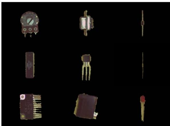
圖 14 本文所使用之常見電子零件圖(依序為：可變電阻、D 型接頭、二極體、DIP 狀 IC、電晶體、電阻、單邊接腳 IC、DC 電源插座、LED)
